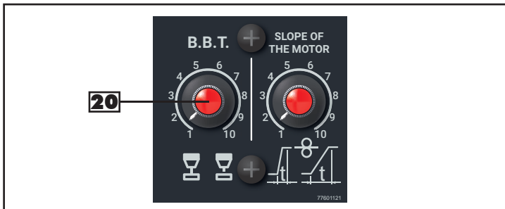
Imagen 9 – Mandos de regulación del BBT (Burn back time) y Rampa Motor (Slope) en el alojamiento de la bobina.
