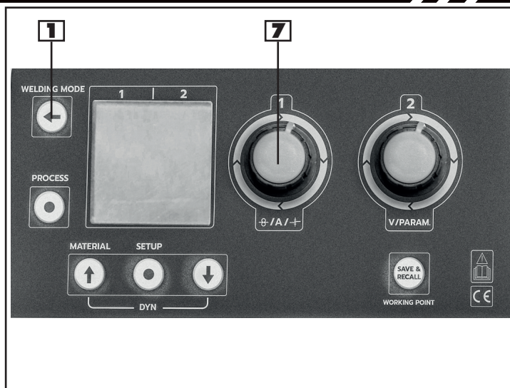
Figura 12 - Pannello di Controllo del generatore - copia
