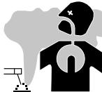
Beim Schweißen entstehen Rauchgase bzw. toxische Dämpfe, die zu Sauerstoffmangel in der Atemluft führen können. Sorgen Sie daher immer für ausreichend Frischluft, technische Belüftung (oder ein zugelassenes Atmungsgerät). oder ein zugelassenes Atmungsgerät.
