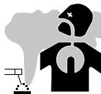
Les fumées, gaz et poussières émis par le soudage sont dangereux pour la santé. Il faut prévoir une ventilation suffisante, un apport d'air est parfois nécessaire. Un masque à air frais peut être une solution en cas d'aération insuffisante. Vérifier que l'aspiration est efficace en la contrôlant par rapport aux normes de sécurité.
